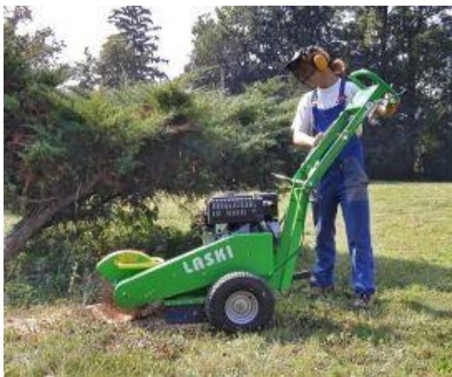
А - измельчитель пней на колесной базе несамоходный
