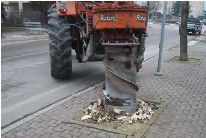
Рисунок 2 – Схема работы роторного измельчителя [3].
