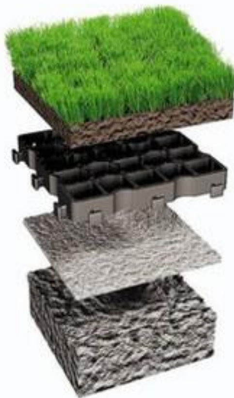
Рисунок 3 – Конструкция экологической парковки
