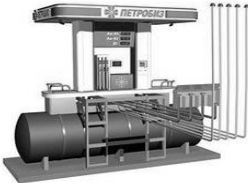
Рисунок 2 – АЗС с подземным резервуаром
