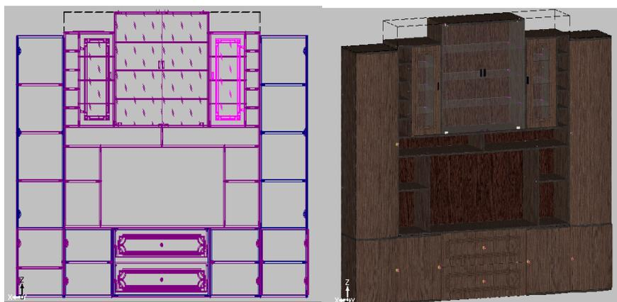
Рисунок 1- Конструкция стенки
