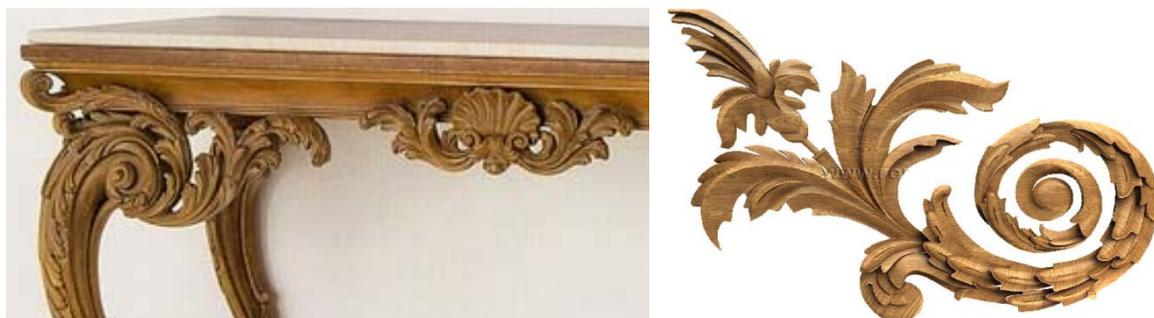
Рисунок 2 – Декоративный элемент изготовленный на фрезерном станке с ЧПУ
