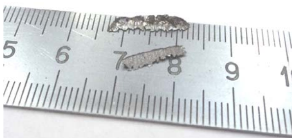
Рис. 1. Фотография нароста, образующегося при ротационном точении винтовой поверхности многолезвийным инструментом с передним углом \gamma = 0^\circ
