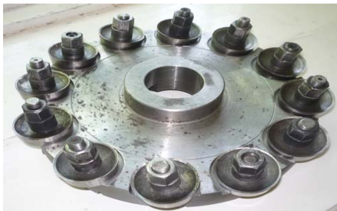
Рис. 4. Ротационная резцовая головка для обработки винтовой поверхности радиусного профиля на глобоидных поверхностях [2]
