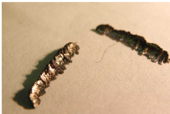
Рис. 3. Нарост, образующийся при ротационном точении винтовой поверхности многолезвийным инструментом с передним углом \gamma = 0^\circ
