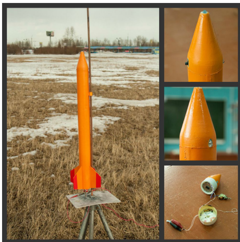
Рис. 4. Запуск ракеты с системой спасения, работающей на светодиодном датчике
