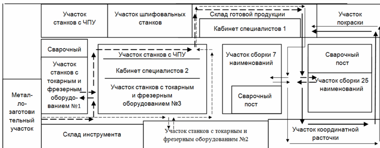
Планировка цеха с изображением маршрута обработки детали после предлагаемых мероприятий
