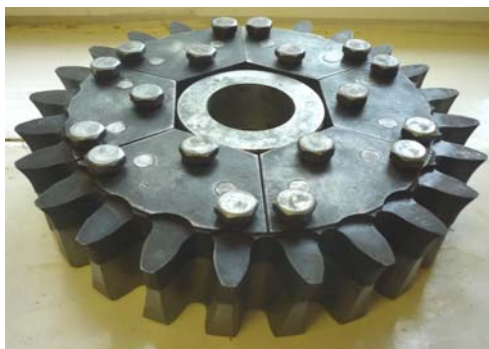
Рис. 1. Ротационная резцовая головка с эвольвентным профилем для нарезания винтовой поверхности глобоидных червяков [2]
