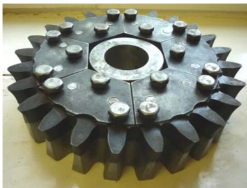
Рис. 3. Многолезвийный инструмент для ротационного точения винтовой поверхности червяков
