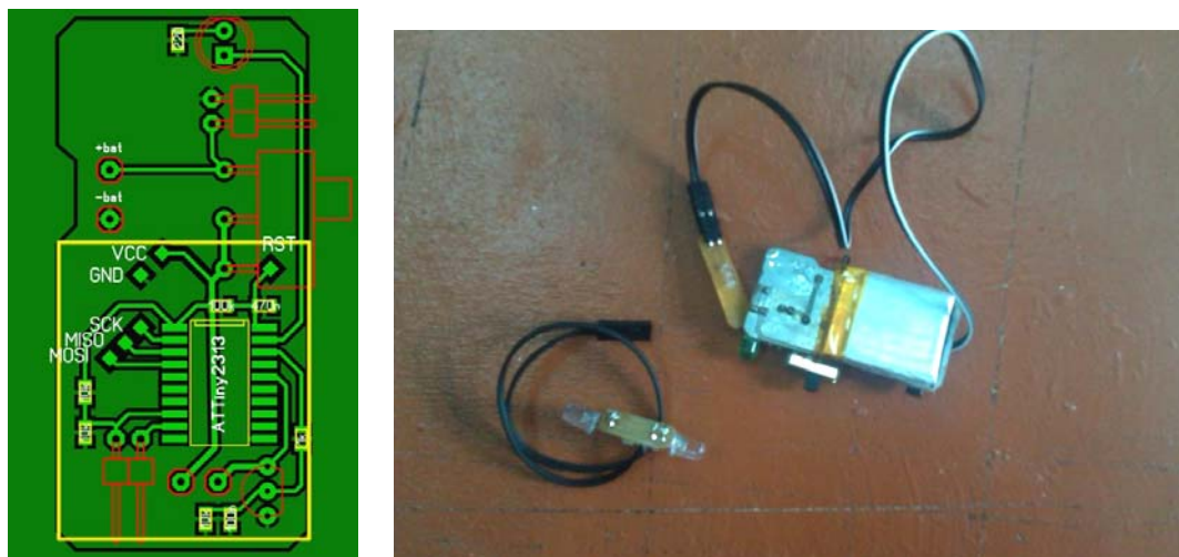
Рис. 3. Светодиодный датчик (финальная разводка)
