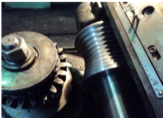
Рис. 2. Обработка винтовой поверхности глобоидного червяка на зубофрезерном станке модели 5К328А
