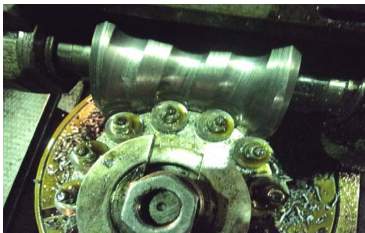
Рис. 5. Обработка винтовой поверхности глобоидного червяка радиусного профиля на зубофрезерном станке 5К328А
