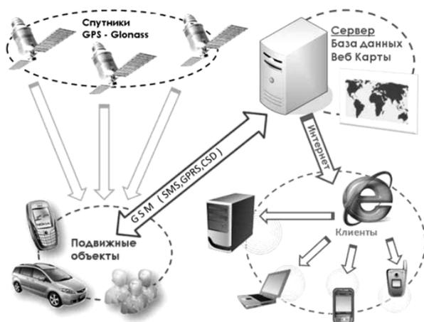
Схема работы спутниковых систем мониторинга транспорта
