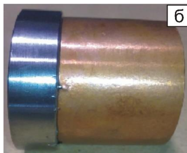
Рисунок 5 - Вид пирамидальной игольчатой структуры (а); неразъёмное соединение «титан – медь» (б); фрагмент микроструктуры в зоне контакта титановой иглы с медной подложкой (в).
