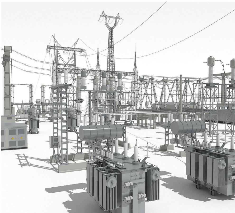
Рисунок 1 – 3D модель тяговой подстанции в ПО Компас 3D
