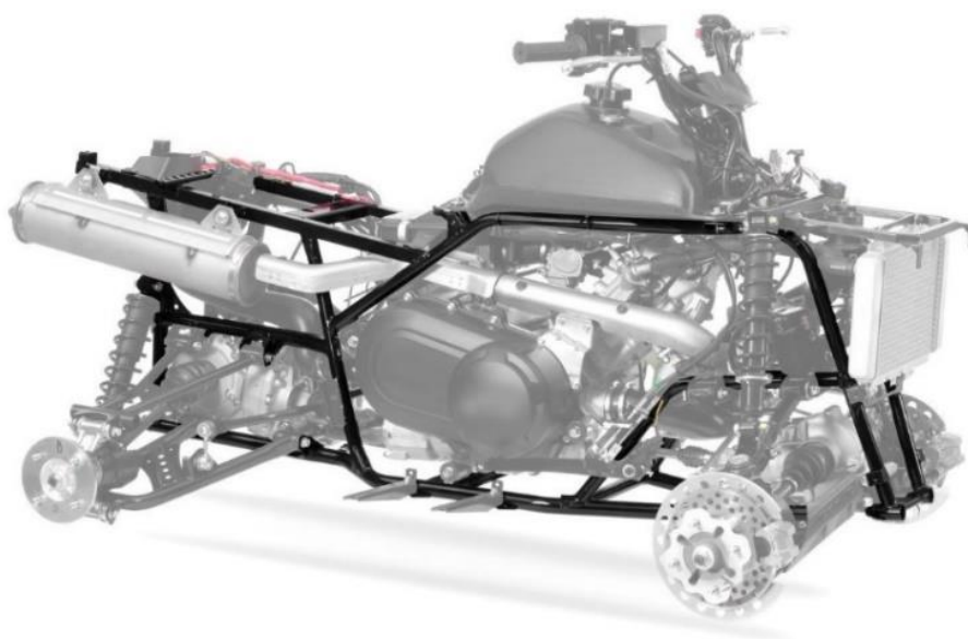
Рисунок 1 – Три посадочные точки для обеспечения эргономичных компоновочных решений
