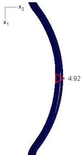
Рис. 4. Конфигурация заготовки после разгрузки в сравнении с формой штампа и максимальные остаточные перемещения в узле на краю трубчатой заготовки
