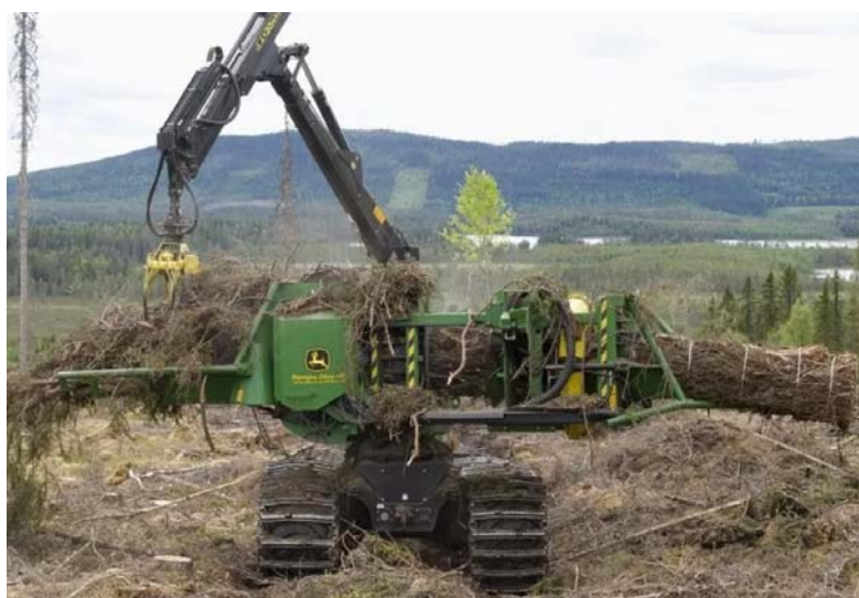
Рис. 2. Харвестер биомассы john deere 1490d
