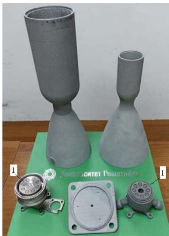
Рис 2. Примеры деталей, полученных методом селективного лазерного сплавления:
