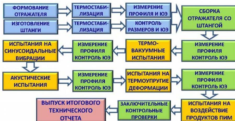
Рис. 3. Блок-схема испытаний рефлектора
