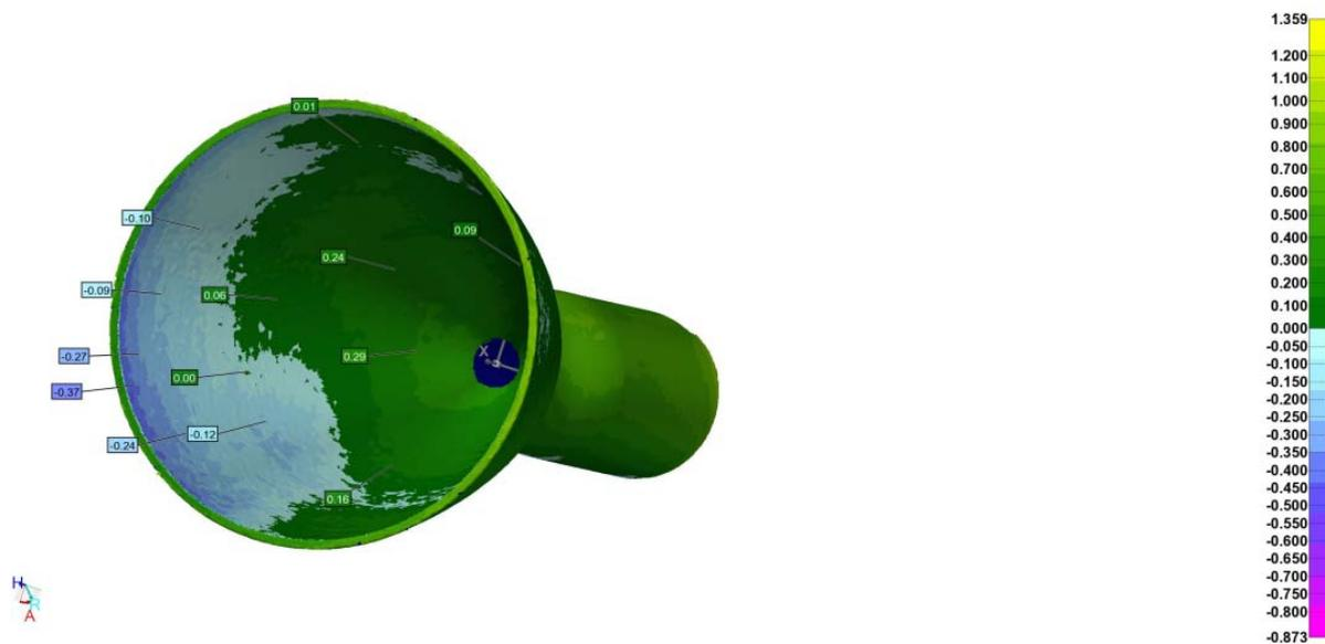
Рис. 3. Распределение отклонения внутренней фактической поверхности камеры-демонстратора от номинальной модели
