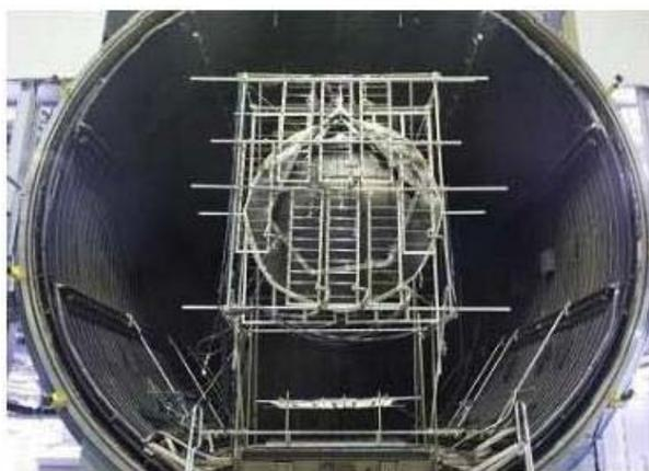
Рис. 6. Рабочее место термовакуумных испытаний рефлектора
