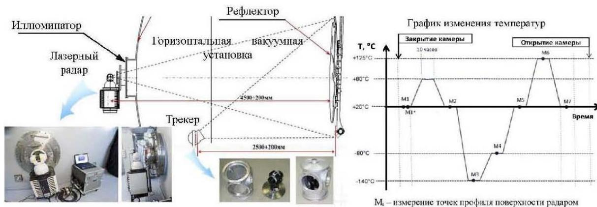
Рис. 9. Рабочее место испытаний рефлектора на термоупругие деформации
