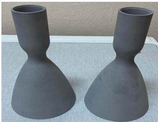
Рис. 1. Образцы экспериментальных камер ракетного двигателя малой тяги, полученных методом селективного лазерного сплавления [2]
