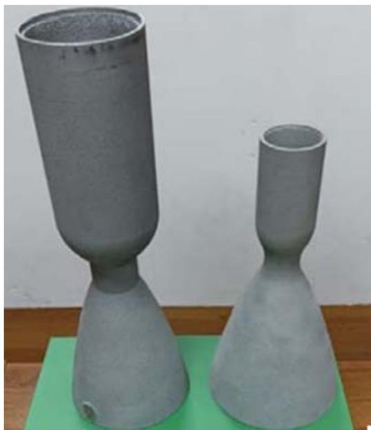
Рис 1. Сопло камеры, полученное методом селективного лазерного сплавления [4]
