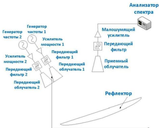
Рис. 10. Рабочее место испытаний рефлектора на воздействие продуктов ПИМ
