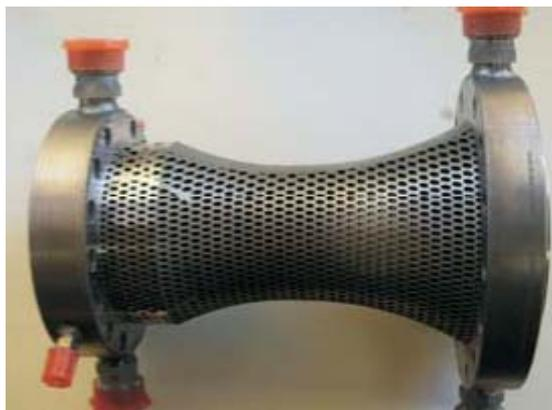
Рис.2. Сопло, изготовленное из Inconel 718 на 3D принтере
