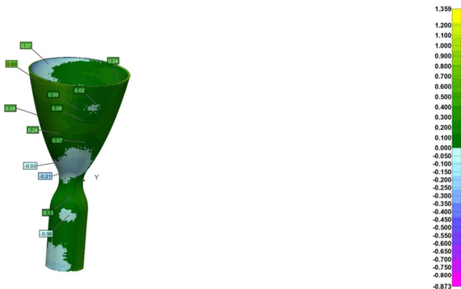
Рис. 2. Распределение отклонения наружной фактической поверхности камеры-демонстратора от номинальной модели
