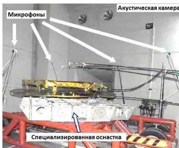
Рис. 8. Рабочее место акустических испытаний рефлектора
