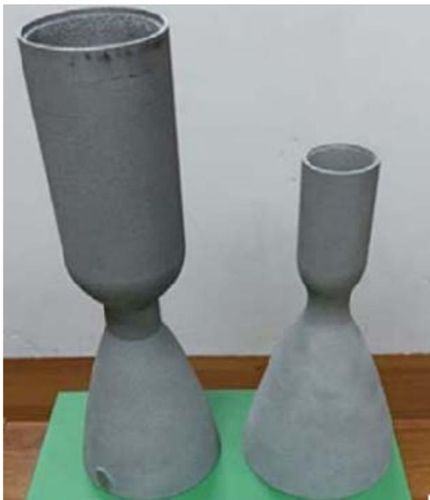
Рис 1. Сопло камеры, полученное методом селективного лазерного сплавления [2]
