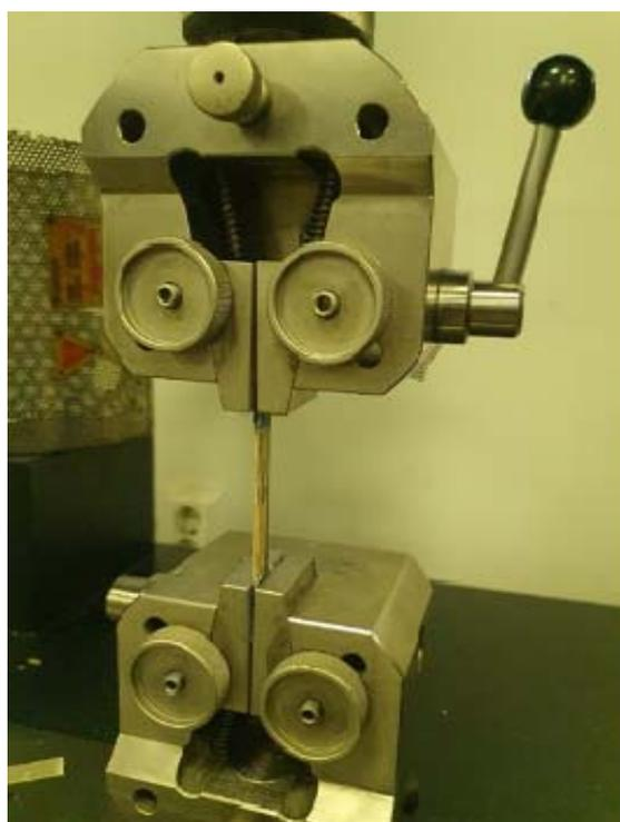
Рис.2 -- Разрыв компонента на испытательной машине Eurotest T-50.
