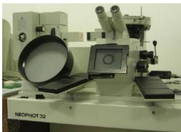
Рис. 3 - Микроскоп Neophot 32.
