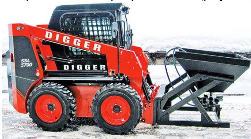
Рисунок 1 – Пескоразбрасыватель на базе малогабаритного погрузчика
