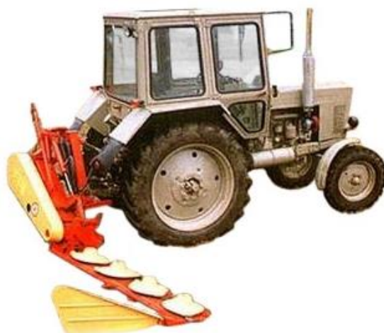
Рисунок 1 - Дорожная машина УДМ82-02 с 4-х роторной косилкой АС-1
