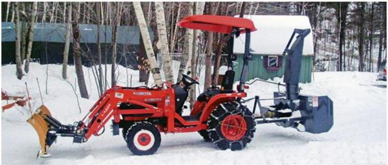
Рисунок 4 – Комплексное использование отвала и роторного снегоочистителя на базе трактора
