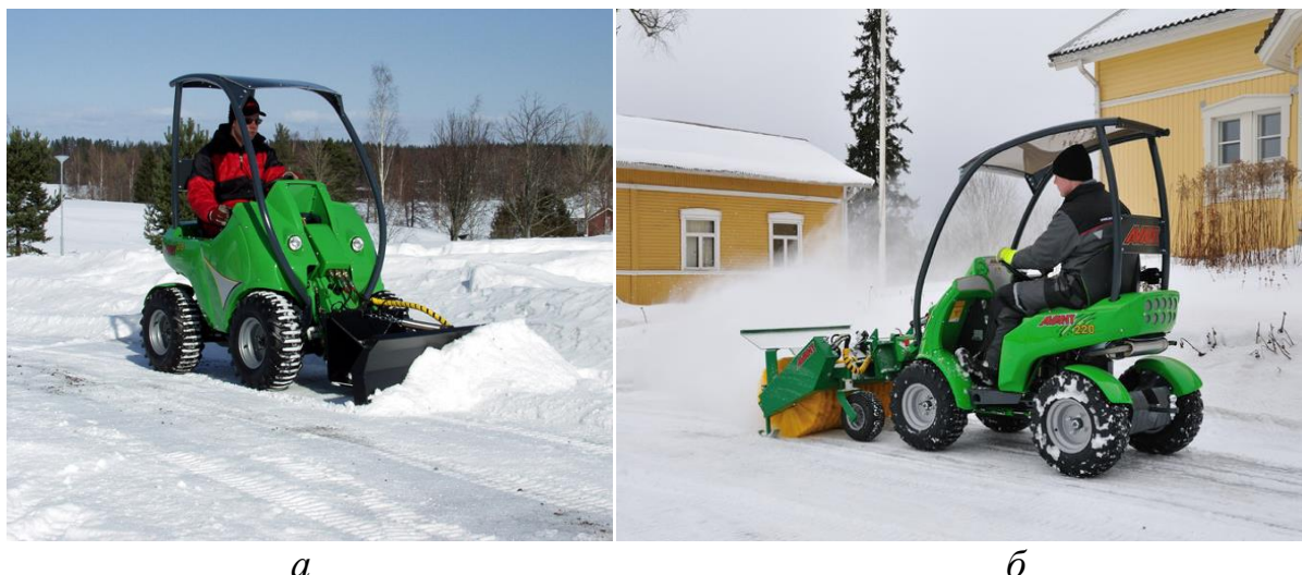
Рисунок 2 – Снегоочистители на базе минитрактора Avant: а – снабженный снеговым отвалом; б – снабженным щеточным оборудованием
