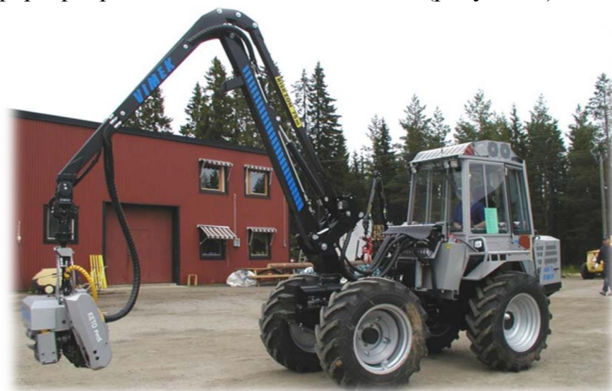
Рисунок 1 – Легкий харвестер Вимек 403 (Швеция)
