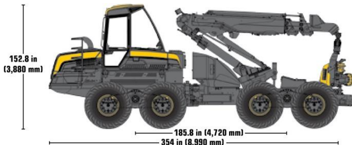
Рисунок 1 - Харвестер Ponsse Bear 8w
