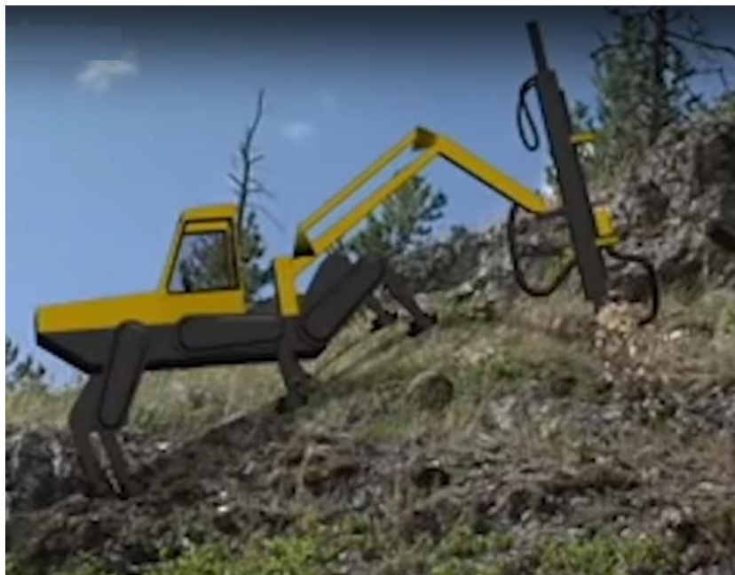
Рисунок 2 - Харвестер Timberjack walking machine (работа на склоне)
