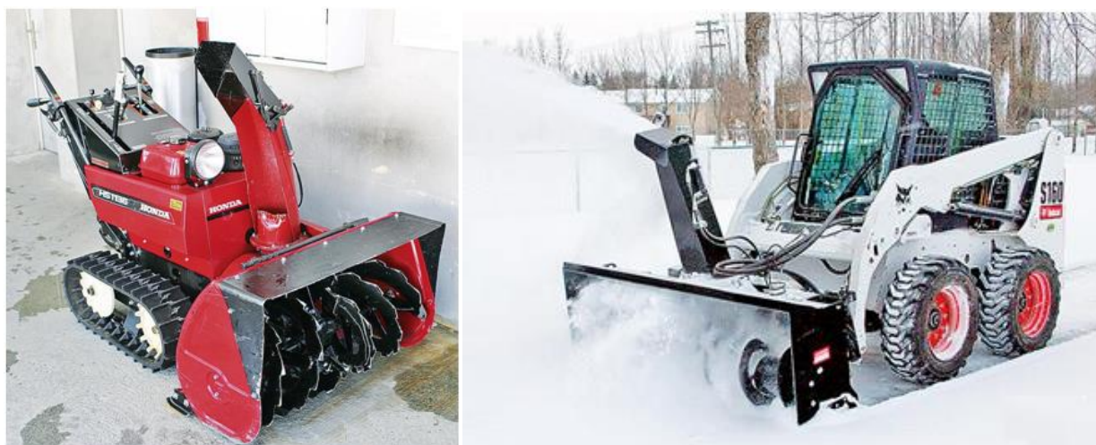
Рисунок 3 – Снегоочистители: а – самоходный фрезерно-роторный; б – роторный на базе малогабаритного погрузчика Bobcat S160
