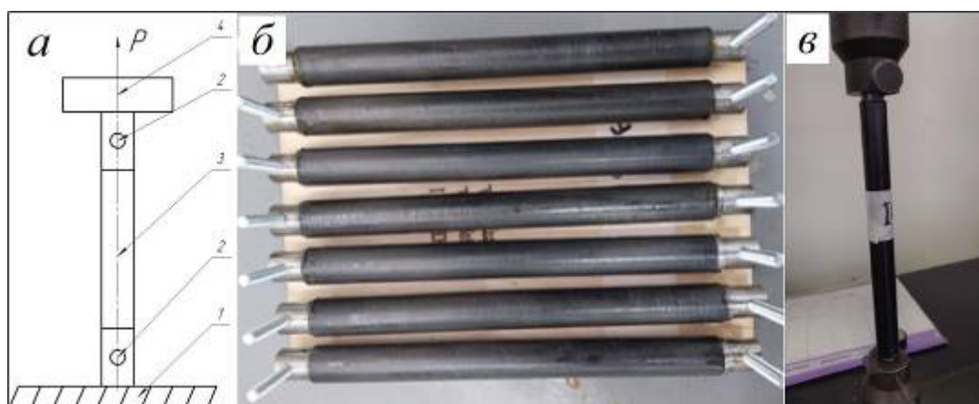
Рис.2. Испытание клеевого соединения, где: а – принципиальная схема испытаний (1 - неподвижная траверса; 2 - законцовки; 3 - образец; 4 - подвижная траверса), б - внешний вид образцов клеевого соединения, в – образец, установленный в разрывную машину
