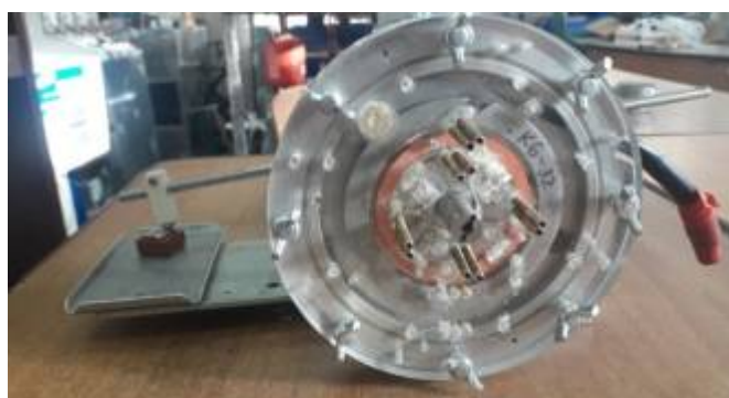
Рис. 2. Экспериментальная установка с приемниками полного и статического давления
