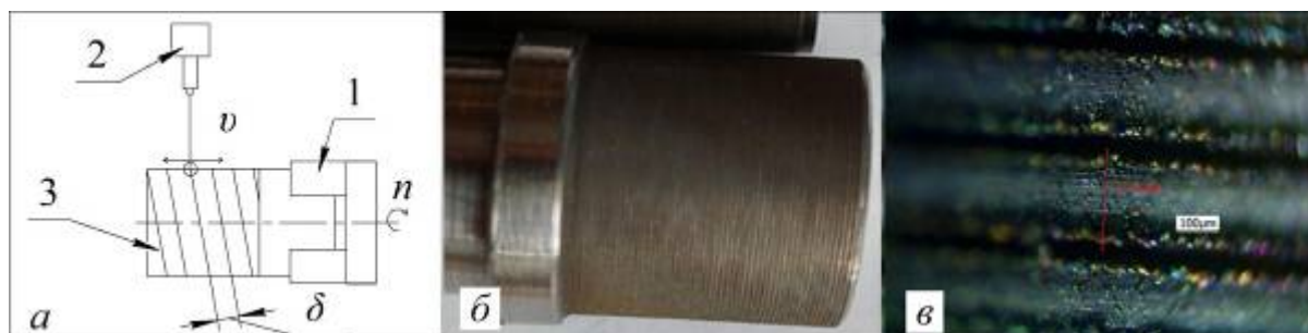
Рис. 1. Лазерная обработка поверхности тела вращения
