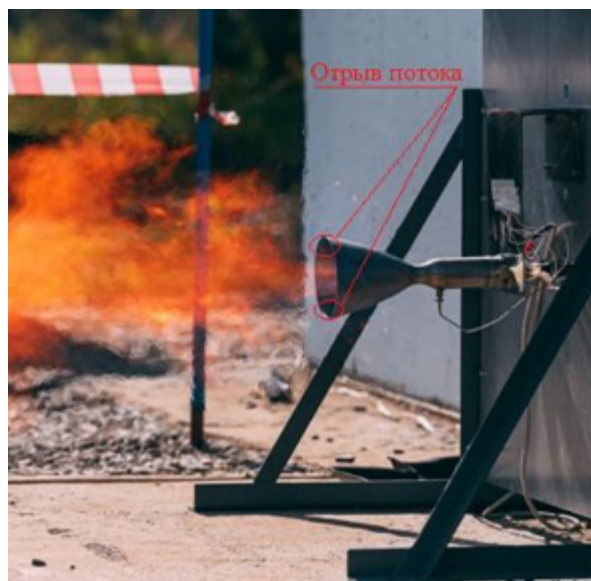
Рис. 2 – Работа РМДТ в режиме перерасширения
