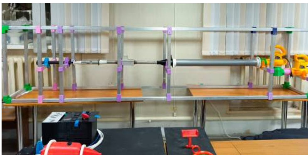
Рис.4. Общий вид собранного стенда для установки экспериментального образца исследования и измерения динамического ППС для развивающегося и динамически стабилизированного течения
