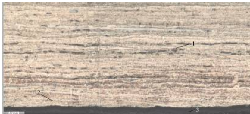
Рис. 5. Структура материала образца, разрезанного вдоль осевой линии канала (микрошлиф): (увеличение 3.81 кх)
