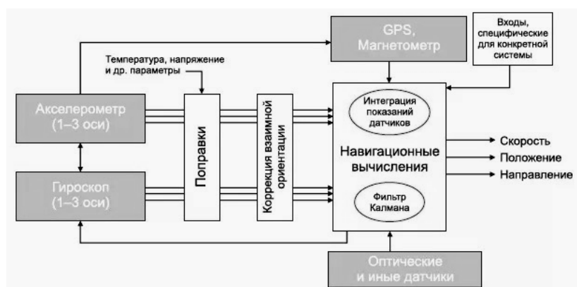
Рис. 2 – Инерциальные навигационные системы с совмещением показаний от разнородных датчиков при помощи фильтра Калмана
