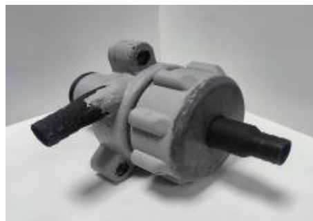
Рис. 8. Насос, изготовленный методом FDM-печати
