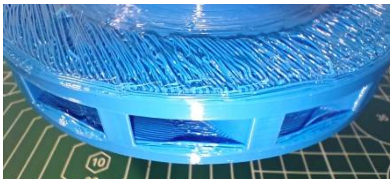
Рис. 5. Рабочее колесо насоса после удаления сетчатых поддержек: видны следы на лопатках и сколы на кромках
