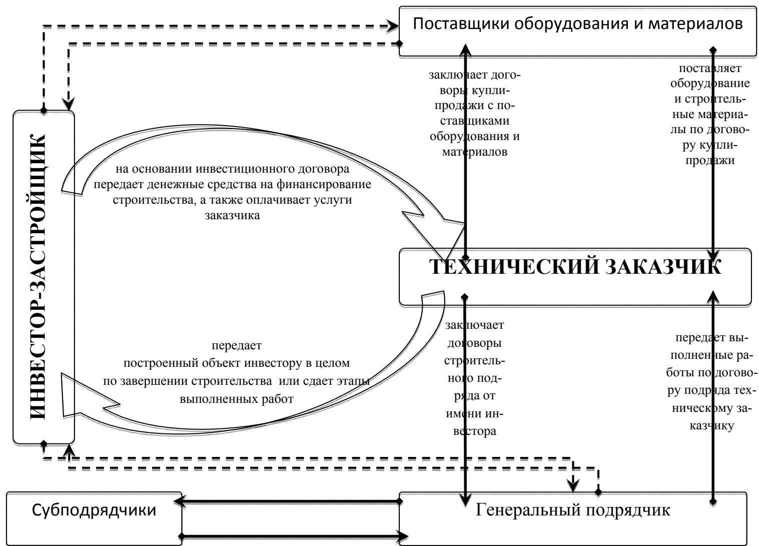
Рис. 1. Схема договорных взаимоотношений участников строительства при создании объектов производственного назначения
